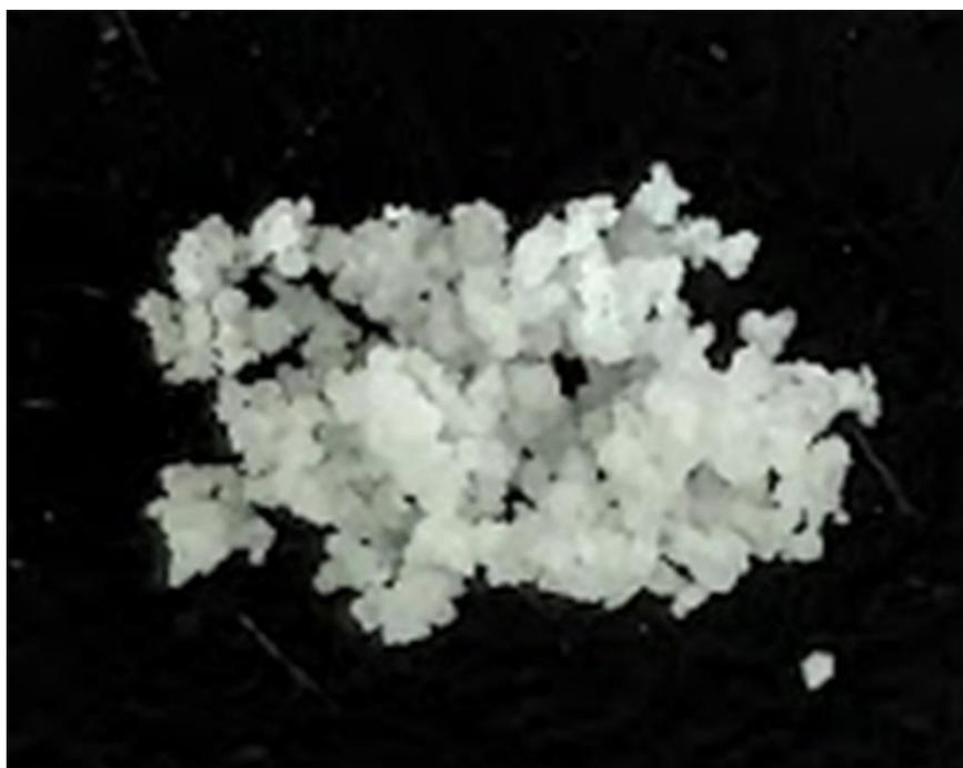
図4 ホウ酸ガラスマトリックスに閉じ込めたアンモニア固体の常温における外観写真.
